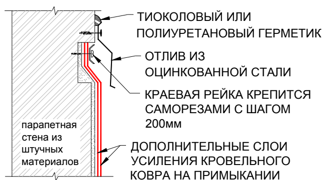
Рис. 24 Заведение края кровельного ковра под выдру в парапетной стене.
