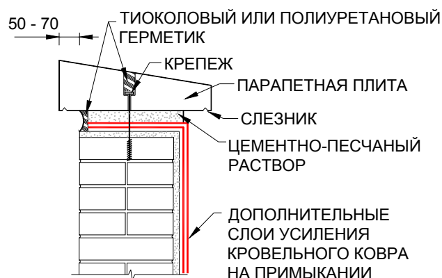
Рис. 27 Примыкание кровельного ковра к парапетной стене с парапетным камнем.
